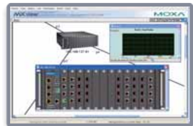
Визуализация лицевой панели устройства, включая отображение портов и светодиодных индикаторов
